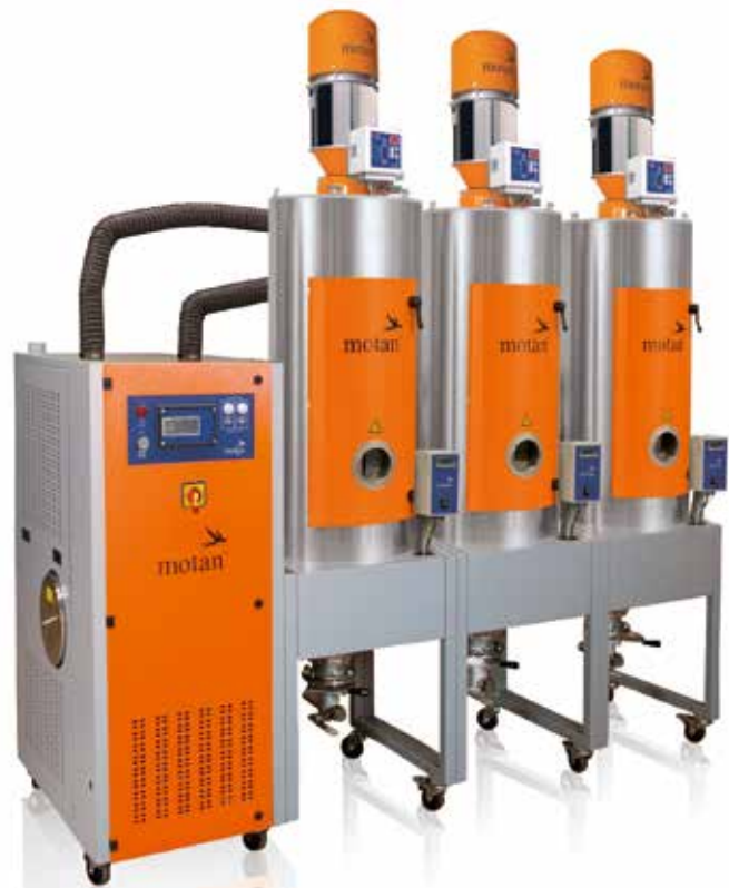
LUXOR S 160 S mit 3 x 150 l Trichtern
